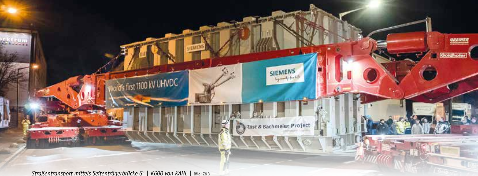
Straßentransport mittels Seitenträgerbrücke G 2 | K600 von KAHL | Bild: Z&B
