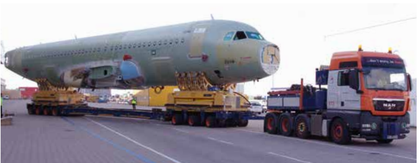
Abwechslungsreich und anspruchsvoll Die Transportaufgaben von Berufskraftfahrern sind vielfältig. Das Foto zeigt den Rumpf eines A 320 „am Haken“ einer Zugmaschine von Universal Transport.
