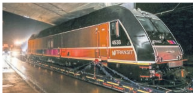
Zentimeterarbeit: Um Brücken zu passieren, muss der Anhänger hydraulisch abgesenkt werden.
