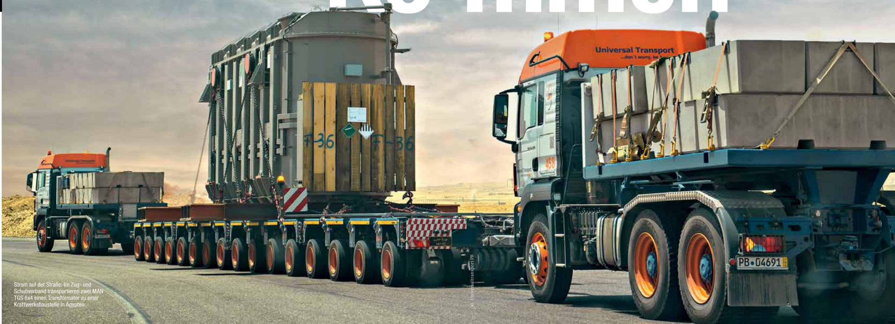
Strom auf der Straße: Im Zug- und Schubverband transportieren zwei MAN TGS 6x4 einen Transformator zu einer Kraftwerksbaustelle in Ägypten.
