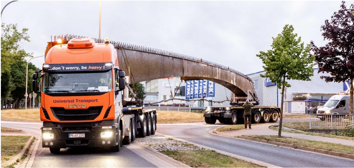
BU: Ein Brückenträger auf dem Weg von Thüringen nach Paderborn
