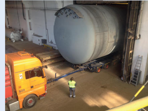
Der Schwertransport mit einer Transporthöhe von 7,40 m bei der Ausfahrt aus der Lagerhalle.
