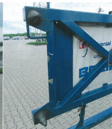
Leichter und komplett vom Boden aus bedienbar: der neue Fertigteile-Innenlader. Solide: Das Heckportal zum Aussteifen der Gesamtkonstruktion
