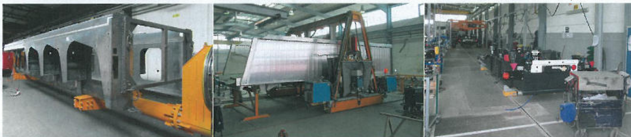
Neu aufgestellt: Innenlader-Rohbau auf Drehgestell, Muldenfertigung mit Ausschweiß-Roboter, neue Fertigungsstraße für die Kippsattel (von links)
