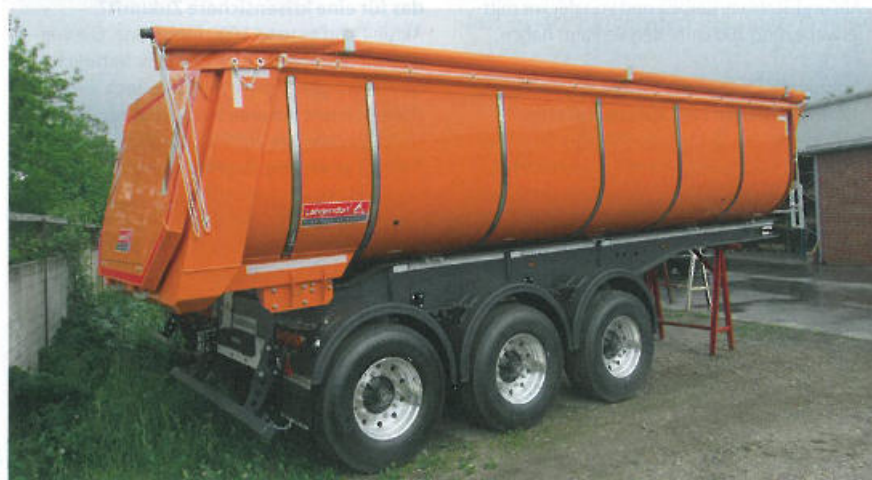
Thermorundmulde aus Stahl mit sauber aufliegendem Deckel, komplett geschraubter Balkon, separate Geber für Absenkautomatik und Fertigerbremse
