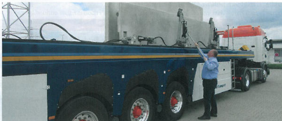
Leichter und komplett vom Boden aus bedienbar: der neue Fertigteile-Innenlader. Solide: Das Heckportal zum Aussteifen der Gesamtkonstruktion
