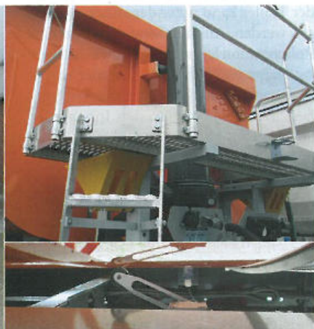
Thermorundmulde aus Stahl mit sauber aufliegendem Deckel, komplett geschraubter Balkon, separate Geber für Absenkautomatik und Fertigerbremse
