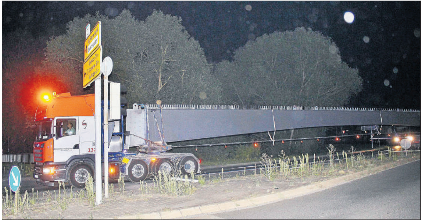
Schwertransport: Nächtliche Fahrt mit einem 17 Tonnen schweren Brückenteil: Der insgesamt 40 Meter lange Schwertransporter fährt von der Firma Lamparter auf die B 7 und dann auf die Autobahn 7.
