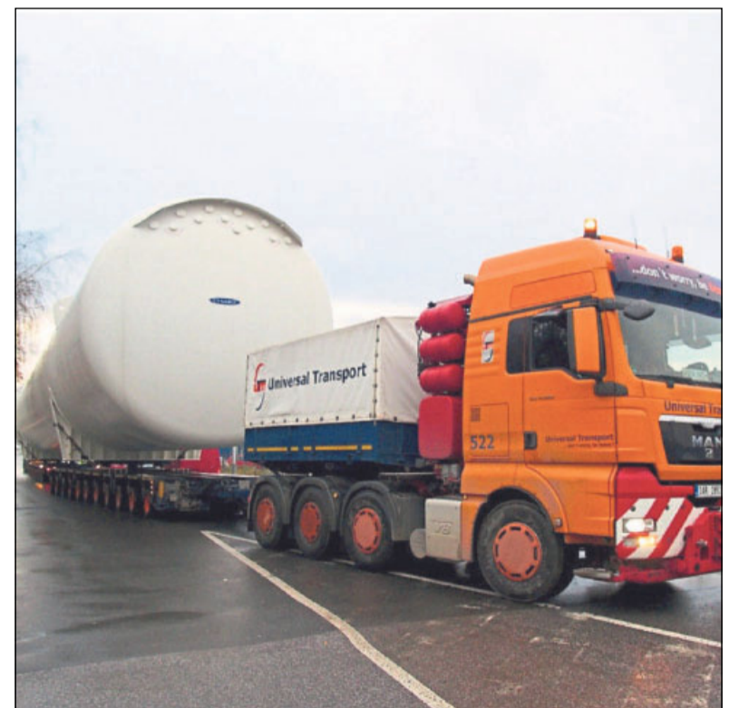
Knapp 400 Tonnen bringt dieses Gespann auf die Straße – reichlich Motorleistung und starke Bremsen sind natürlich unerlässlich.
