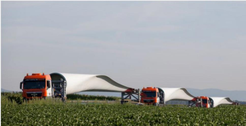
Warum acht Transporte? Die Abmessungen und Gewichte der einzelnen Bestandteile zeigen es: Allein die Turmsegmente haben eine Länge zwischen 23,8 Meter und 24,4 Meter und ein Gewicht bis zu 45,4 Tonnen. Hinzu kommt jeweils noch ein Maschinenhaus mit den Maßen 9,75 x 4,24 x 3,85 Meter und einem stolzen Gewicht von 85 Tonnen. Die drei Rotorblätter sind vielleicht nicht ganz so schwer, dafür haben sie mit 60,06 x 3,62 x 2,77 Meter je Blatt beeindruckende Transportmaße.
