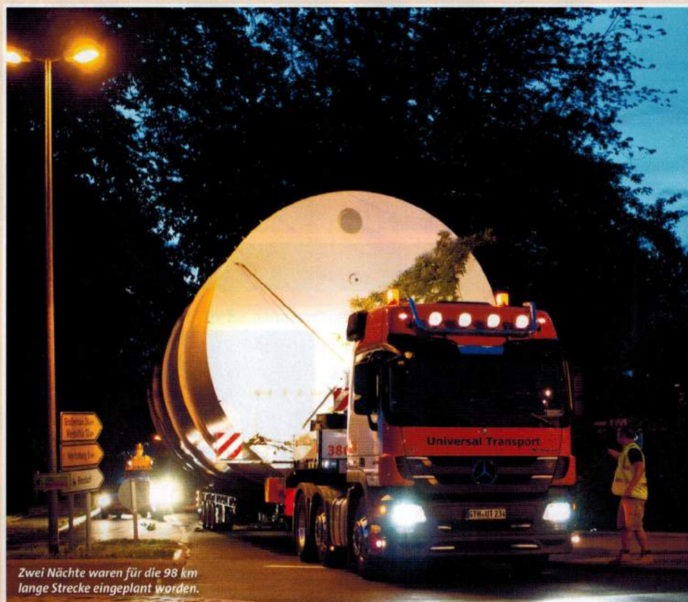
Damit der Transport freie Fahrt hatte, wurden unter anderem insgesamt 58 Telefon- und 30 Stromleitungen angehoben.
