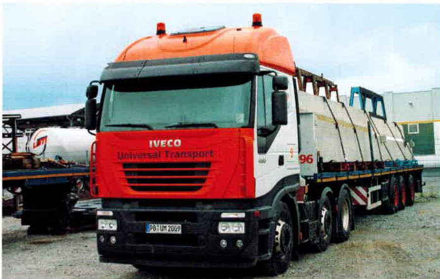
Im Schwertransport haben sich 6x2 mit gelenkter Vorlaufachse bewährt. In dieser Konfiguration stimmen die Achslasten.
