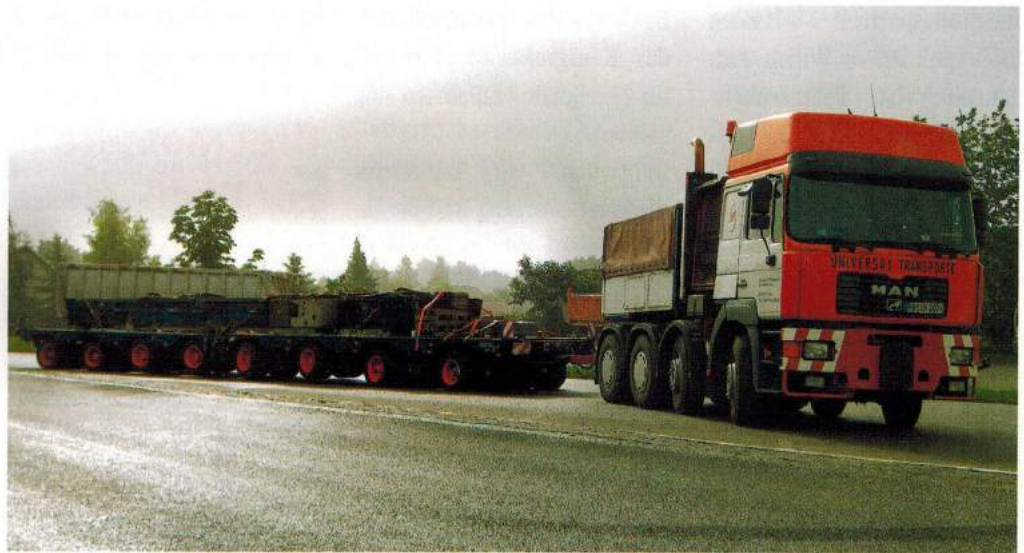
Die vierachsige Zugmaschine und der acht-achsige, teleskopierbare Greiner Anhänger von Universal Transport.
