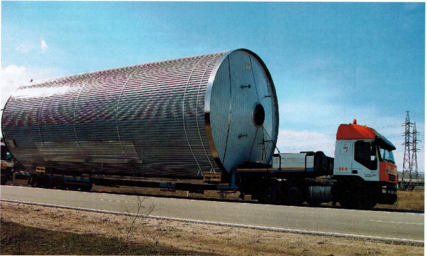
Aufsehen erregte auch der Transport von sechs Biertanks in Rumänien. Jeder der 30-Tonnen-Behälter ist 22 Meter lang und hat einen Durchmesser von 6,60 Meter
