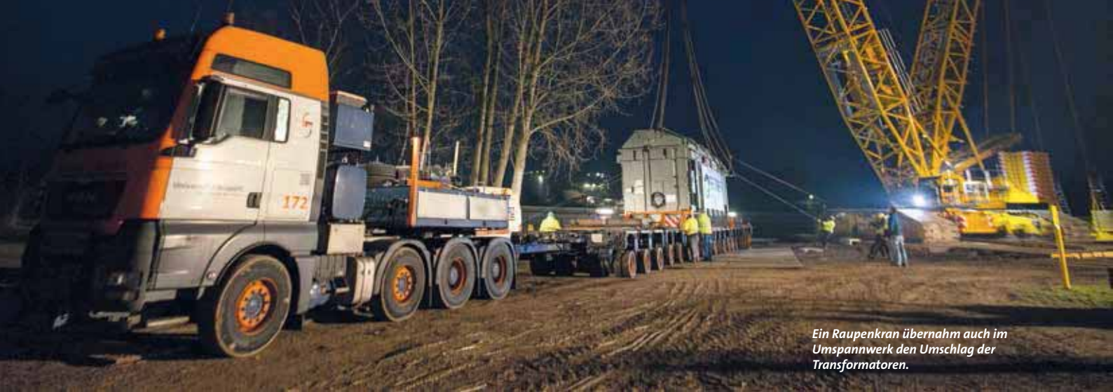
Einer der beiden 261 t schweren Transformatoren hängt schon am Haken ...
