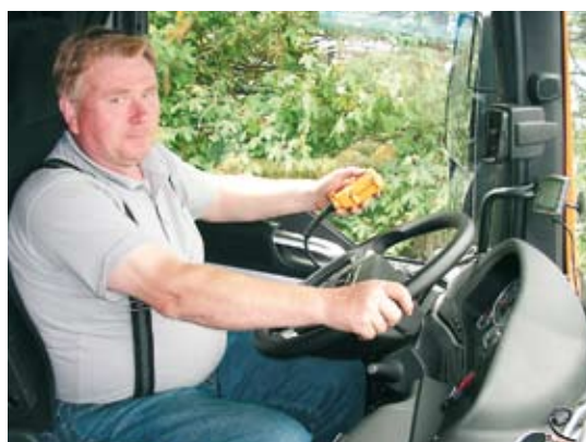
Fahrer Gerd Wesenberg muss in schwierigen Kurven den Nachläufer separat über die gelbe Steuerung nachlenken. Mit über 10 Jahren Erfahrung im Schwertransport hat er auch diese zusätzliche Anforderung immer im Griff.
