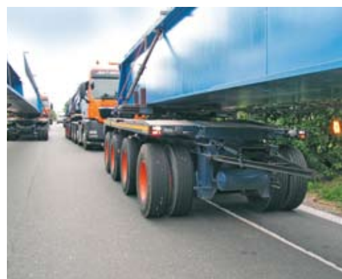
Fahrer Gerd Wesenberg muss in schwierigen Kurven den Nachläufer separat über die gelbe Steuerung nachlenken. Mit über 10 Jahren Erfahrung im Schwertransport hat er auch diese zusätzliche Anforderung immer im Griff.
