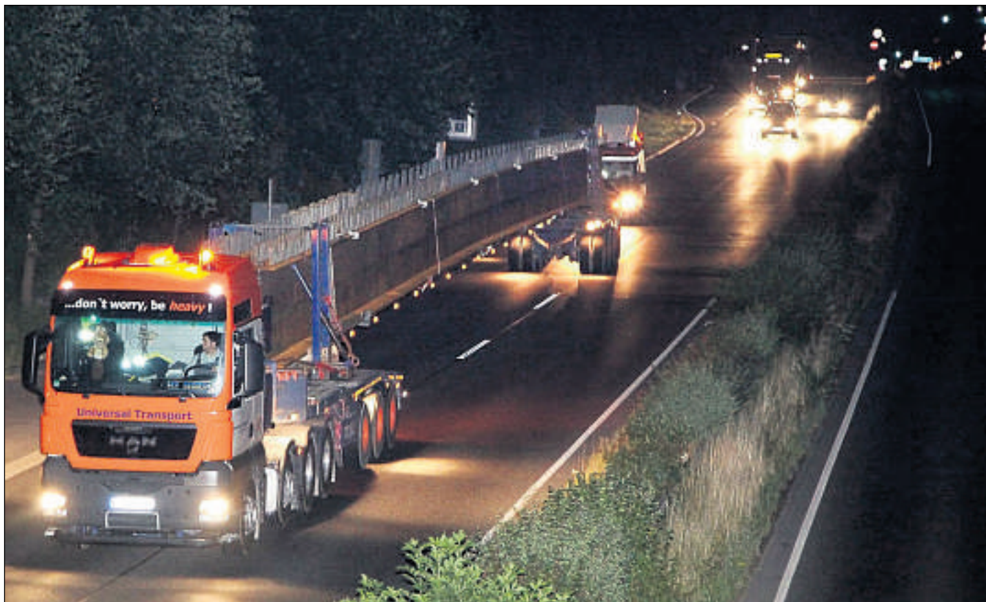
Auf zwölf Achsen durch Kassel: Begleitfahrzeuge sichern den Schwerlast-Lkw auf der Dresdener Straße nach hinten ab. Weil die Fahrzeuge vor allem in Kurven extrem langsam fahren müssen, dürfen solche Fahrten nur nachts stattfinden.
