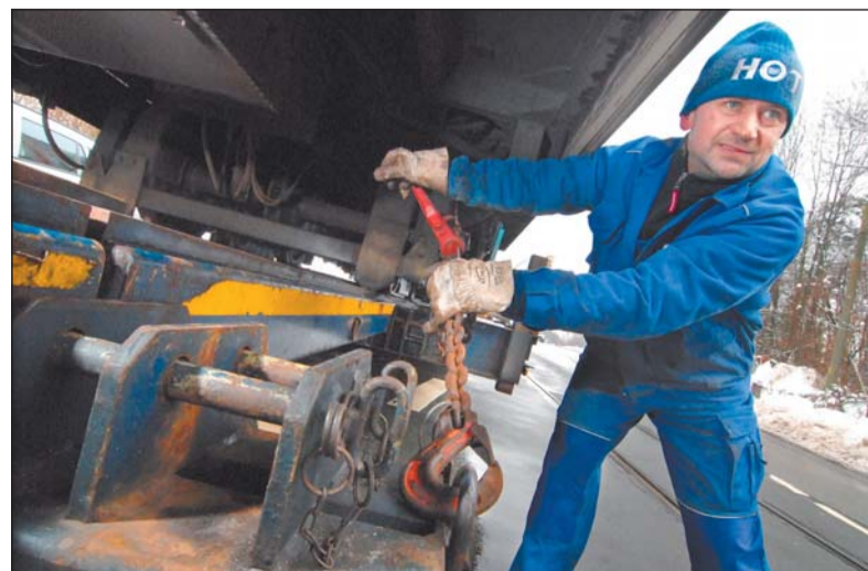
Universal-Transport-Mitarbeiter Axel Hornhoff zieht die Straßenbahn mit Hilfe eines Kettenseilzuges noch ein paar Zentimeter weiter auf den Lkw.
