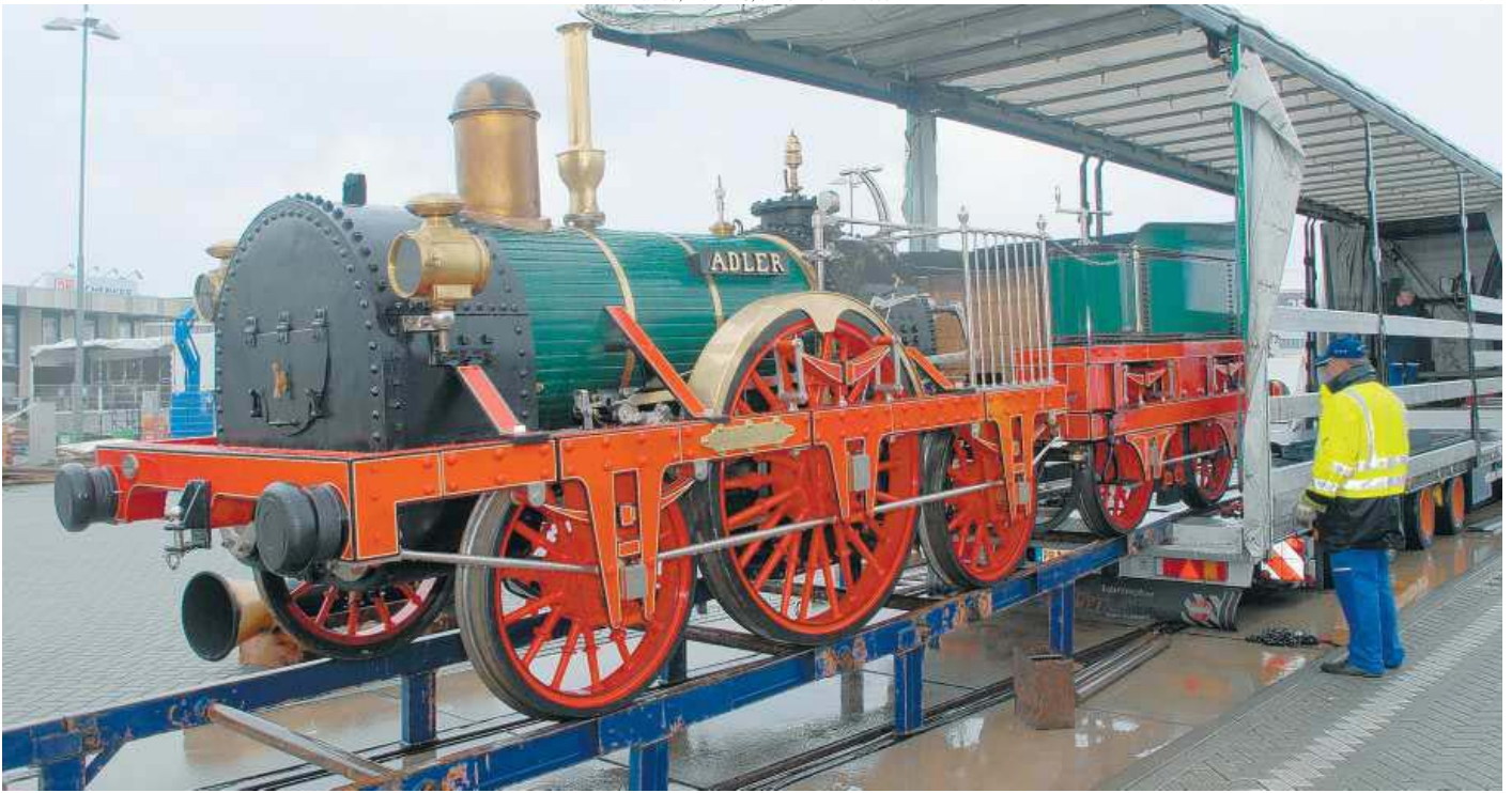
Schätze auf Achse: Diese historische Adler haben die Mitarbeiter besonders gern auf den Lkw verfrachtet. Ans Gleisbett wird eine Rampe angelegt und dann geht es mit Hilfe einer Seilwinde auf das Fahrzeug.
