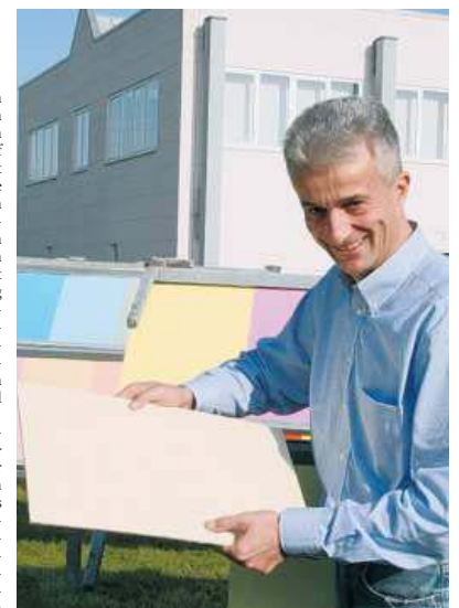
Der Wetterstand: Auf dem Außengelände werden Proben der Farben Wind und Wetter ausgesetzt. Laborleiter Matthias Bartel prüft die einzelnen Platten.
