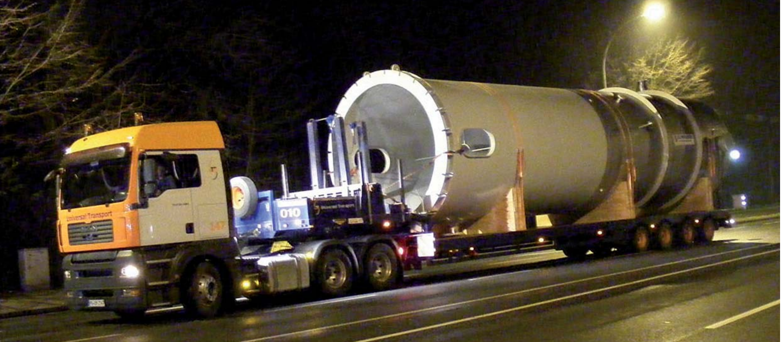
Das Foto zeigt einen von zwei Schwerlast-LKW des Transport-Spezialisten Universal Transport, mit denen Druckbehälter von Enningerloh zum Binnenhafen Münster-Hiltrup gebracht wurden. Von dort erfolgte die anschließende Verschiffung der Behälter via Hamburg in den Iran.
