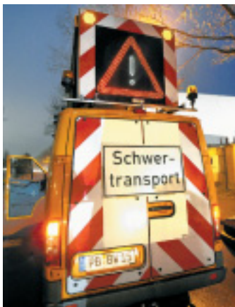
Begleiter: Das Fahrzeug mit Warntafel sichert den Konvoi.
