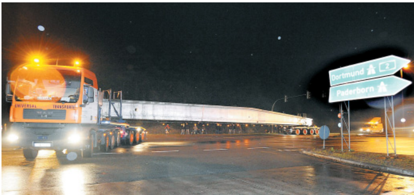
Geschafft: Der 48 Meter lange Schwertransporter biegt von der B 68 auf die Autobahn 2 Richtung Dortmund ein. Der Fahrer blickt aus dem Fenster und überprüft, ob der Abstand passt. Das Begleitfahrzeug folgt ihm in kurzem Abstand.
