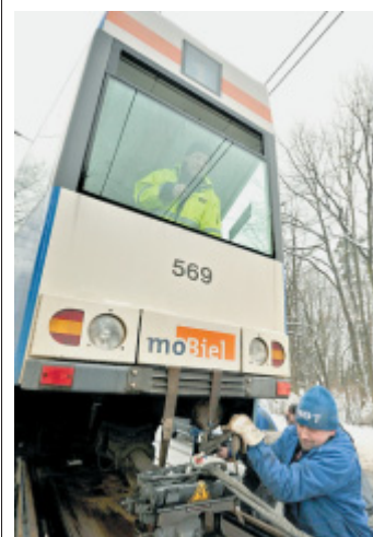
Körperersatz: Axel Hornhoff hebt mit einem Spanngurt die Kuppelung der Bahn an.
