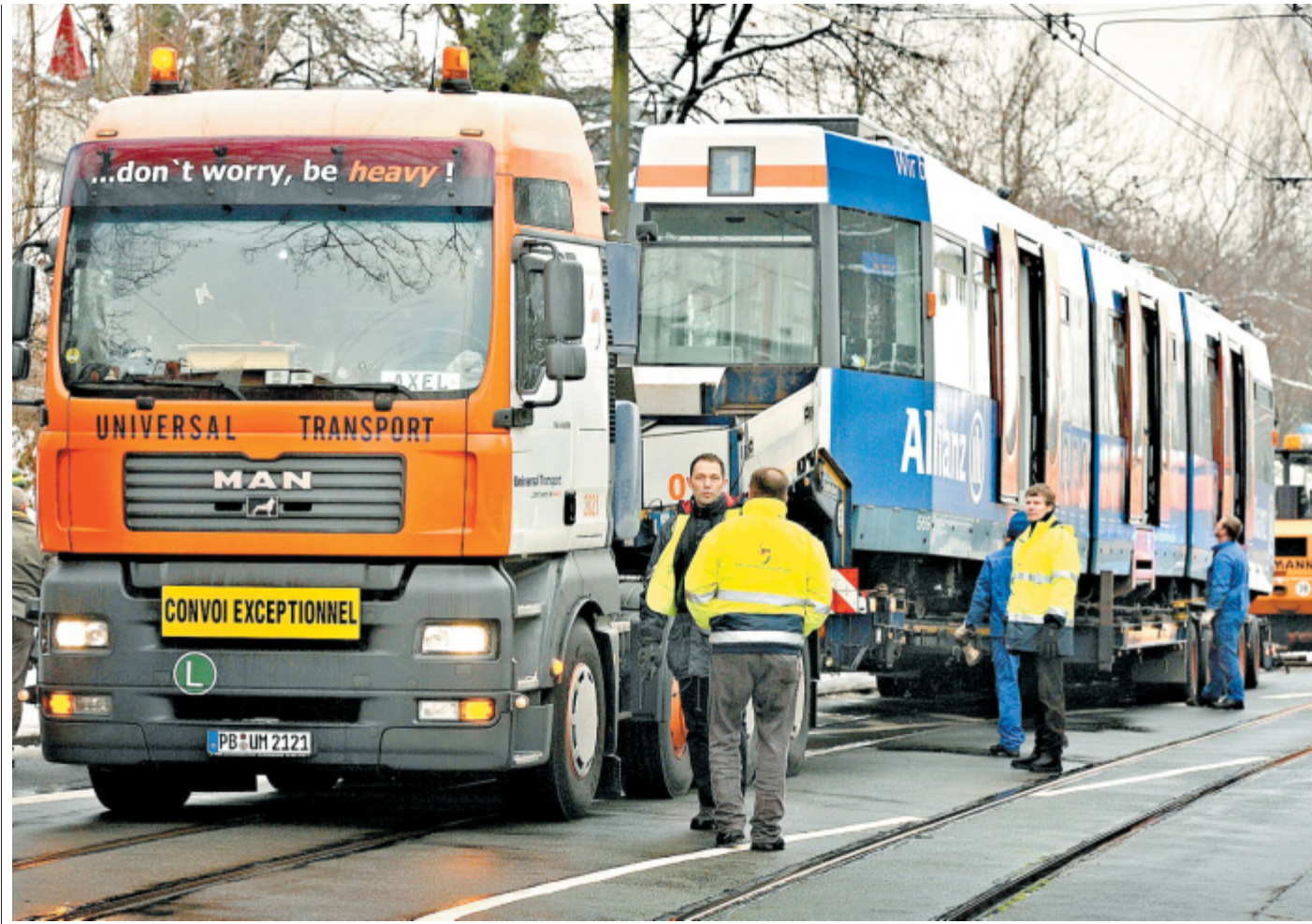
Ungewöhnlicher Schwertransport: Gegen 14.30 Uhr ist die erste der beiden beschädigten Bahnen auf dem 40 Meter langen Transporter verladen. Dann heißt es warten – die Fahrt des 90 Tonnen schweren Gespanns darf erst nach 22 Uhr starten. FOTOS: ANDREAS FRÜCHT
