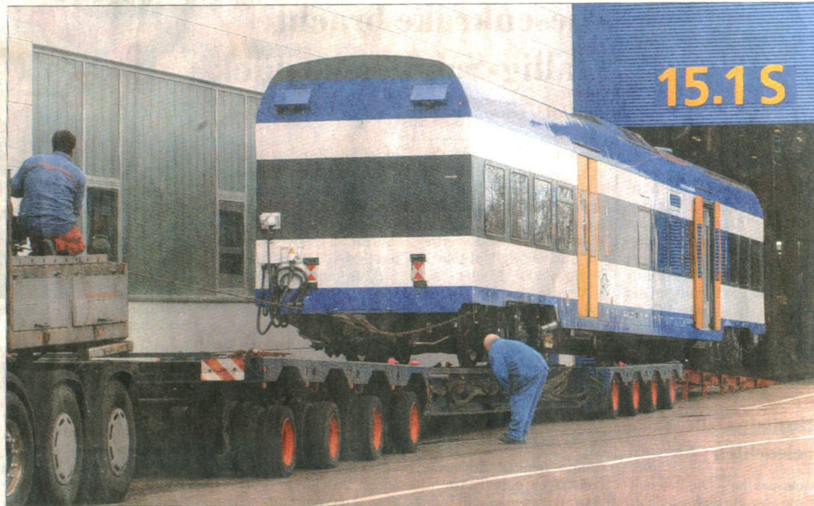
Viele Gummiräder unter dem Waggon: Das Bahnfahrzeug auf dem Tieflader.
