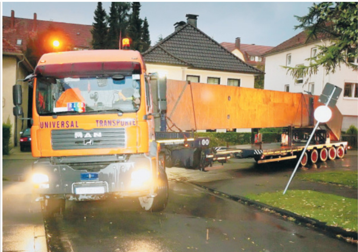
Knifflige Stelle: Der Schwertransporter biegt von der Melanchthonstraße auf den Parkplatz der Schüco-Arena ab. Er hat einen Betonpfeiler für den Umbau der Osttribüne geladen. Das Gefährt ist insgesamt 80 Tonnen schwer und rund 25 Meter lang. FOTOS: THOMAS F. STARKE
