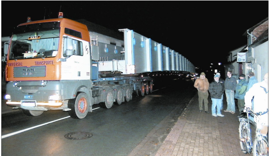
Mit dem Vier-Achs-Sattelzug vorneweg war der Brückentransport sogar 64 Meter lang. Über die Feldstraße ging es ohne Probleme. Das Schwierigste sollte noch kommen: das Wendemanöver auf der Kreuzung Hauptstraße/Feldstraße. Fotos (2): Wenck
