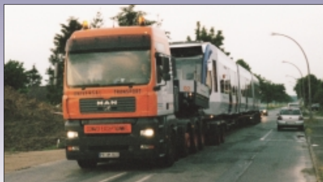
Jetzt muss der Wagen noch hydraulisch in die Waagrechte gebracht werden, dann gehts am Abend los
