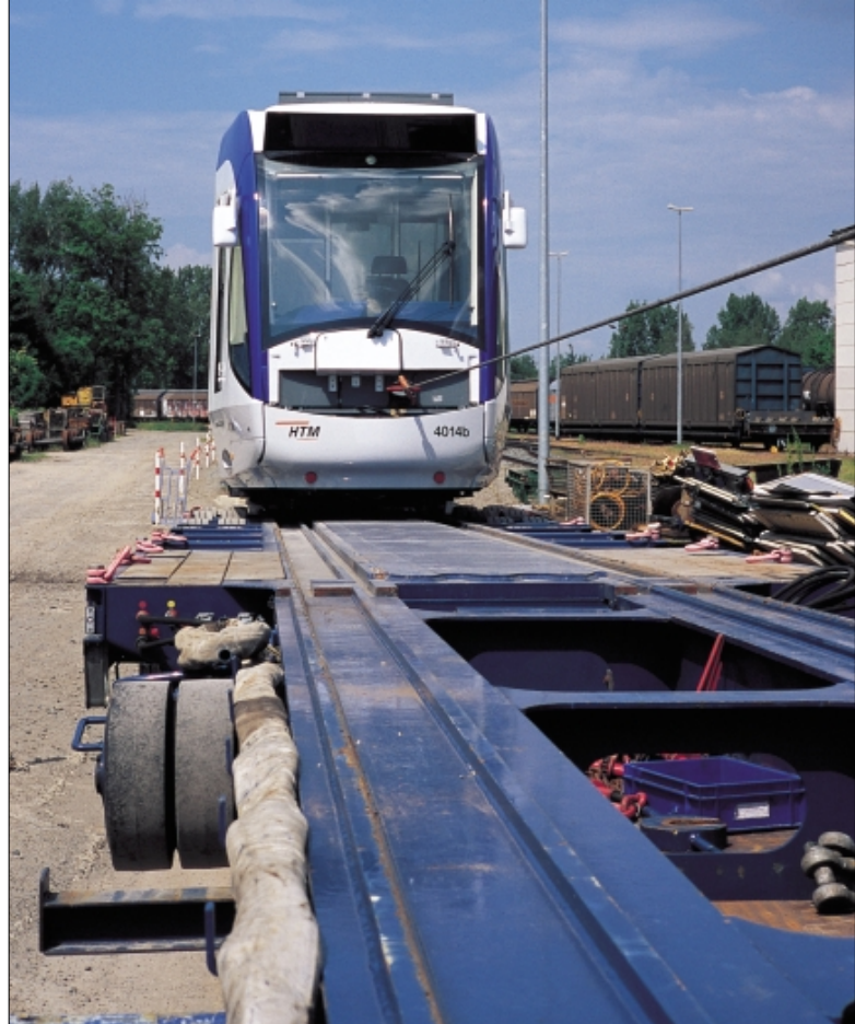
Zentimeter für Zentimeter zieht das Stahlseil den Wagen auf die Ladebrücke
