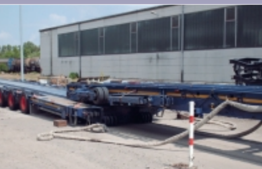
Am Ladegleis wird die Ladebrücke zwischen Dolly und Trailer gehängt und mit starken Bolzen befestigt
