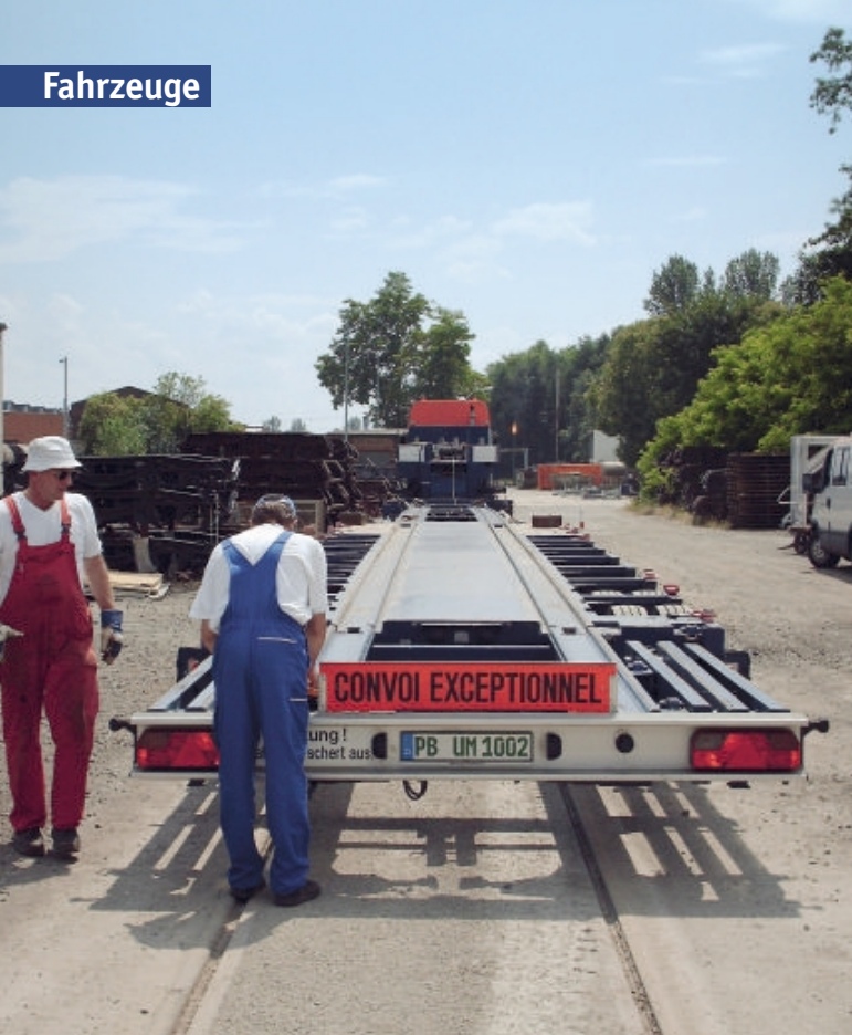
Die Rampe zum Auf- und Abgleisen wird am Tieflader mitgeführt
