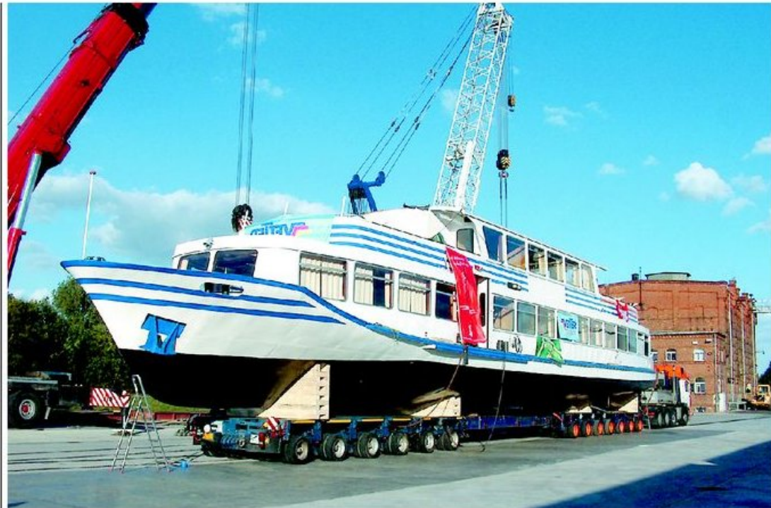
Schiff auf der Straße: Das war auch für das Paderborner Transportunternehmen eine Premiere, als sie ein Ausflugsschiff vom Rhein auf einen See in die Nähe von Bitterfeld transportierten. 100 Tonnen wiegt der Koloss, speziell angefertigte Holzstützen tragen die Last auf dem Anhänger.
