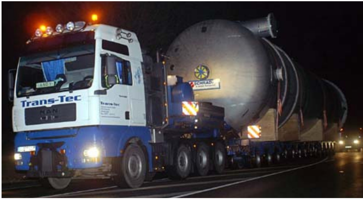
Der riesige Stahlzylinder braucht enorm Platz. Fahrer Ronny Knoblauch muss sich Zeit nehmen und genau hinsehen, weil seine Fracht schwerfällig ist. 600 PS hat er für die 131 Tonnen unter der Haube. Fotos: Peter Schniederjürgen
