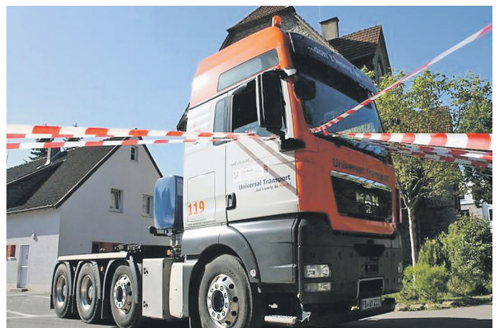
Der LKW von der Seite. Die Bänder zeigen den „toten Winkel“.
